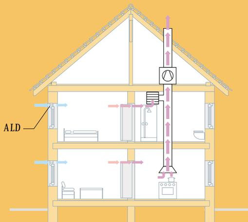
Ein Ventilator saugt Luft aus den stark belasteten Bereichen – Küche, Bad, WC – ab und bläst diese über einen Kanal nach außen.
