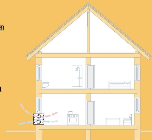
Die Lüftung ist in mehreren Stufen regelbar und lässt sich gut an die Raumnutzung anpassen. Jedes Lüftungsgerät benötigt eine Zuluft- und eine Abluft-Öffnung in der Fassade. Achten Sie besonders auf leise Ventilatoren, damit Sie nachts ruhig schlafen können.
