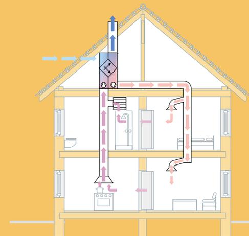
Fast alle Zu- und Abluftanlagen bieten Wärmerückgewinnung; d. h. die kalte Außenluft wird durch die Abluft erwärmt – ohne Gerüche und Feuchte aufzunehmen. Bei effizienten Anlagen ist die Zuluft fast so warm wie die Raumtemperatur – sogar im Winter. Sie sparen Heizkosten und vermeiden kalte Zugluft.
